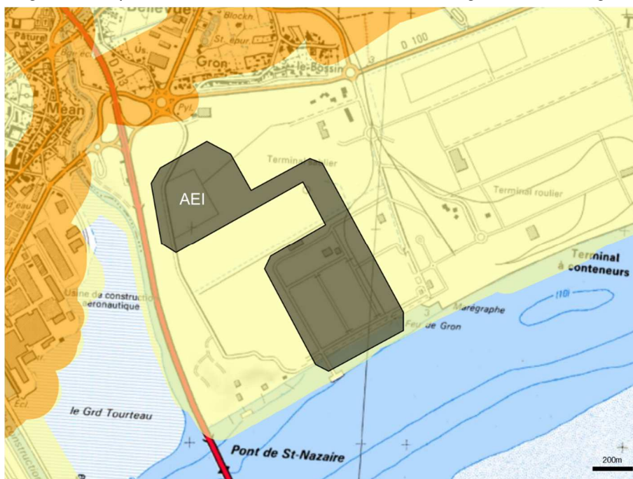
Figure 37 : Exposition de la zone d'étude à l'aléa de retrait et gonflement des argiles
