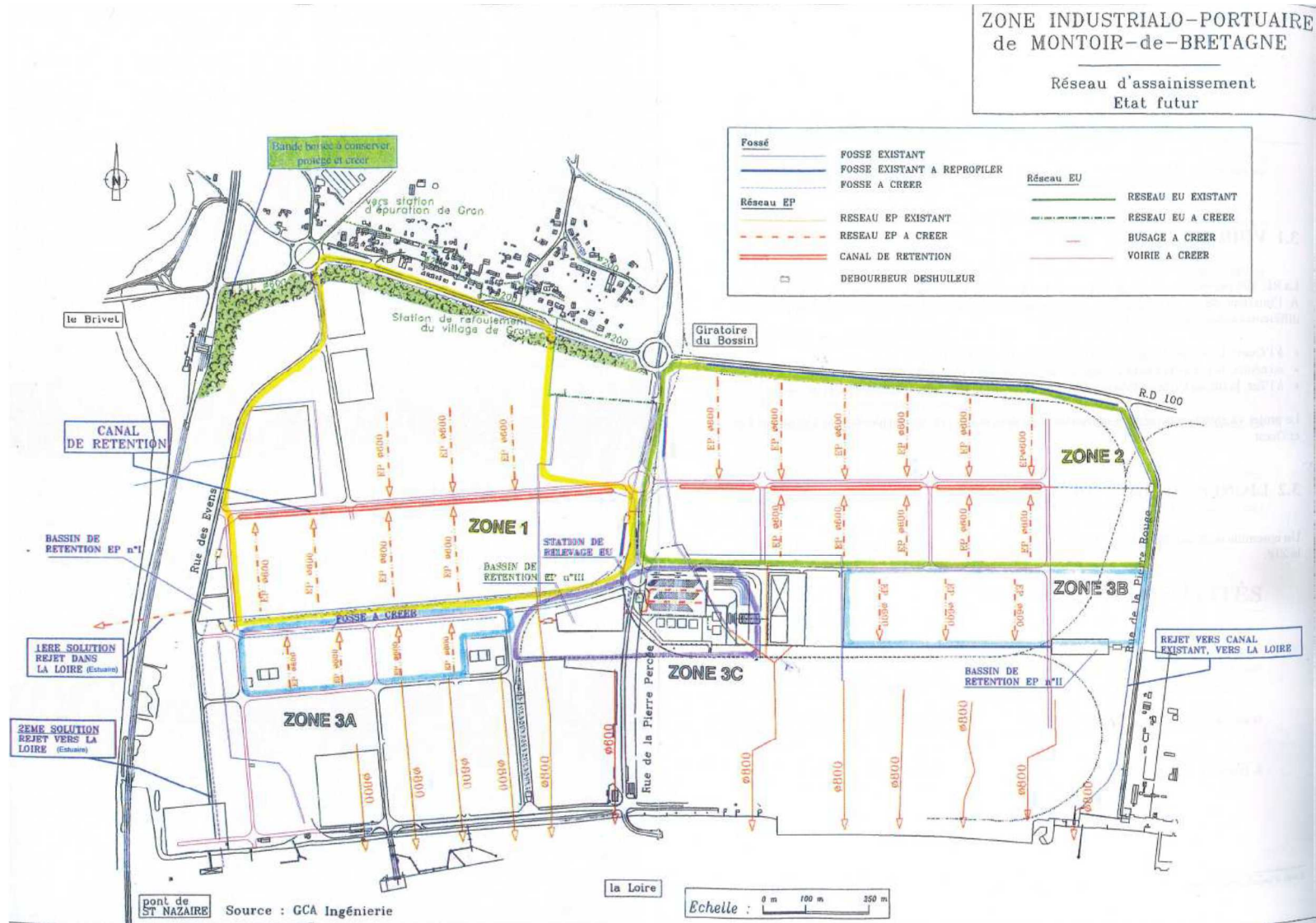
Figure 18 : Zone industrialo-portuaire (ZIP) de Montoir-de-Bretagne
