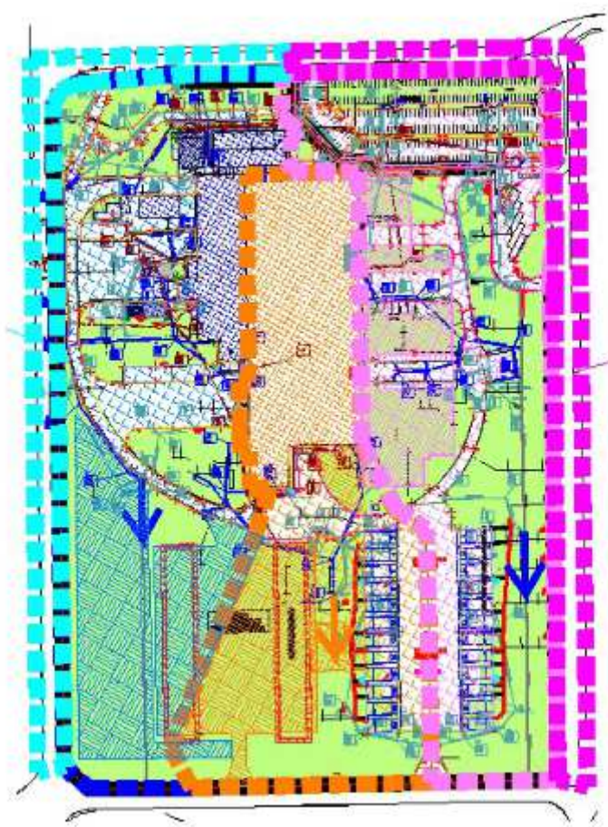
Figure 123 : Bassins versants et canalisations de gestion des eaux de ruissellement installés sur le site de l'usine GE
